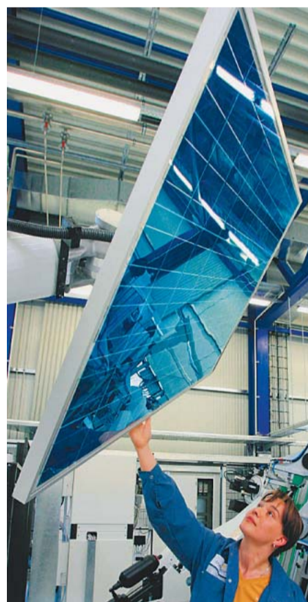
Kontrolle eines Solarmoduls Foto Zentralbild
